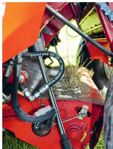
**Der Kanalboden kann bei Verstopfungen bequem vom Traktor aus abgesenkt werden.**
