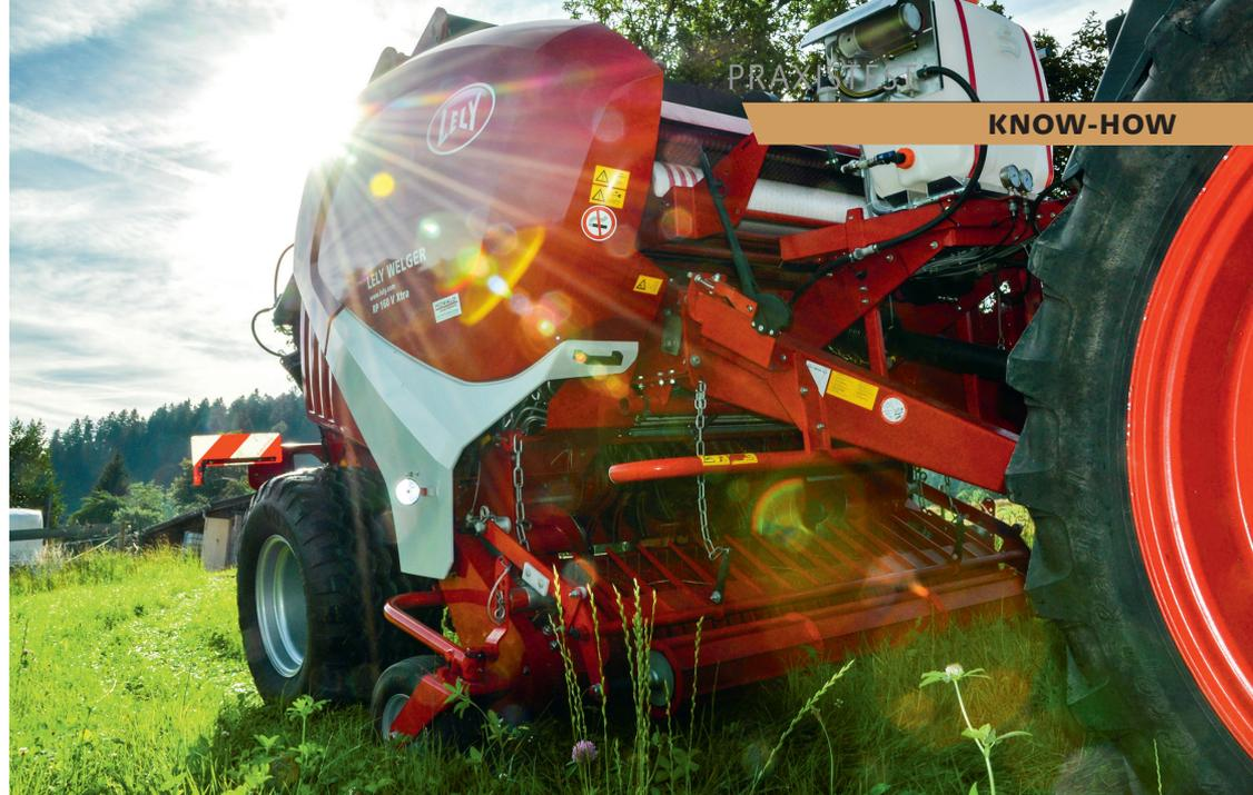
**Mit der variablen Presse Lely Welger RP 160 V können Ballen von 90 cm bis zu 1.6m Durchmesser hergestellt werden.**
